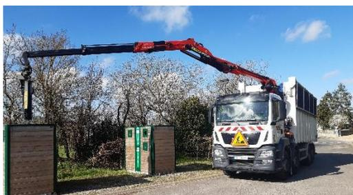
1 polybenne équipée d'une grue
